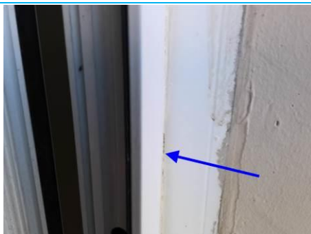
Matériaux : ZPSO-030 Prélèvement : P040 Description : Joint étanchéité entre bâti zlu et cadre Localisation : 1er étage - PALIER Résultat : Absence d'amiante
