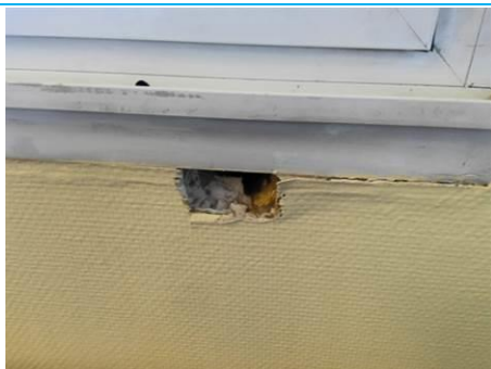
Matériaux : ZPSO-001 Prélèvement : P001 Description : Isolant intérieur fibreux Localisation : 2ème étage_Aile droite - Bureau 210 Résultat : Absence d'amiante
